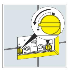
Die Verriegelung der Bauschutzplatte um 90° gegen den Uhrzeigersinn drehen.
