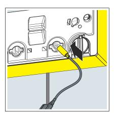
Wenn eine elektronische Betätigungsplatte verwendet wird und damit die obere Öffnung für das Anschlusskabel der Antriebseinheit erforderlich ist, das Kabel unten durch die Bauschutzplatte in den Spülkasten führen.
