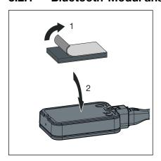
Die Schutzfolie des Klettstreifens lösen.
