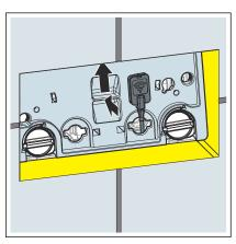
Die Bauschutzplatte in den Spülkasten einsetzen.
