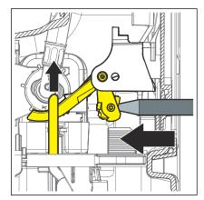
Die Funktion der Auslösemechanik prüfen (z.B. mit einem Kugelschreiber).
