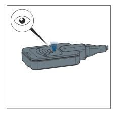
Die LED blinkt blau. Die Spannungsversorgung ist hergestellt.
