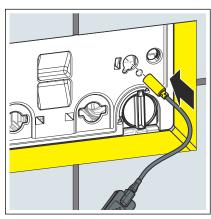
Wenn eine manuelle Betätigungsplatte verwendet wird, das Kabel oben durch die Bauschutzplatte in den Spülkasten führen. Wenn das Y-Kabel verwendet wird, das Kabel unten durch die Bauschutzplatte in den Spülkasten führen.
