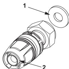
1 8790202 Flachdichtung 3/4" für flachdichtende Verschraubungen
