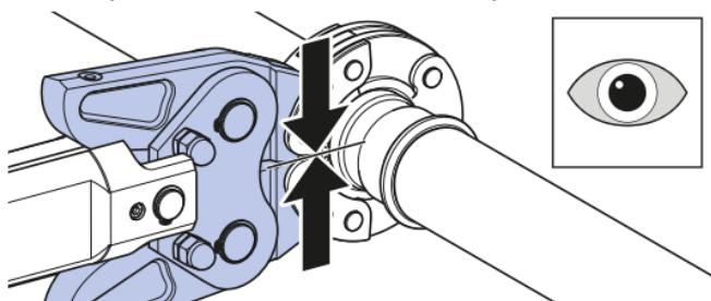
**3** Deschideți adaptorul colierului de presare Geberit și desfațeți-l de la colierul de presare Geberit.
