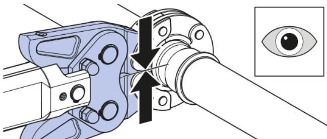
**3** 打开 Geberit 挤压口适配器，将其脱离 Geberit 挤压口。
