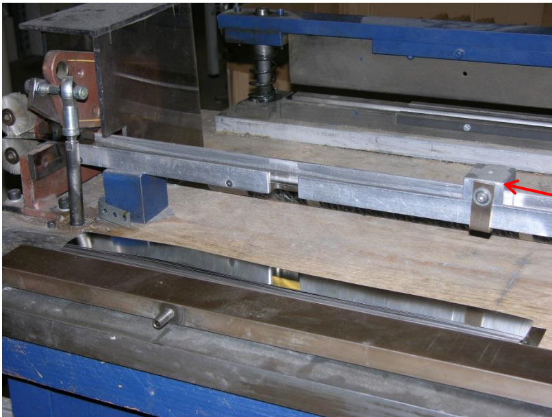
Anschlag für Längeneinstellung
