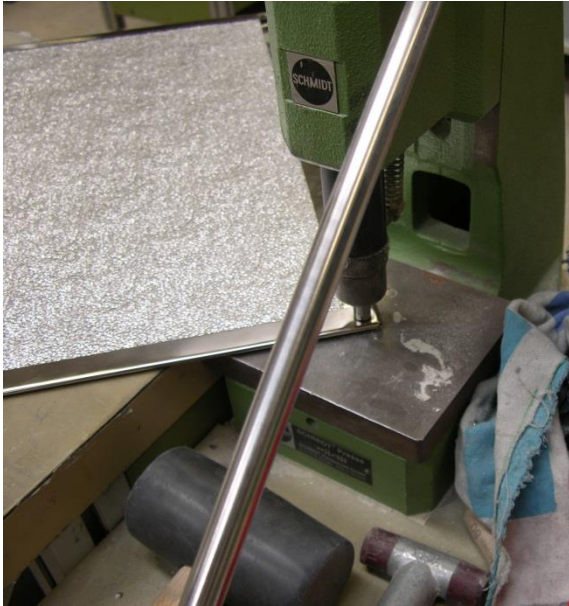
Mit Kniehebelpresse vernieten
