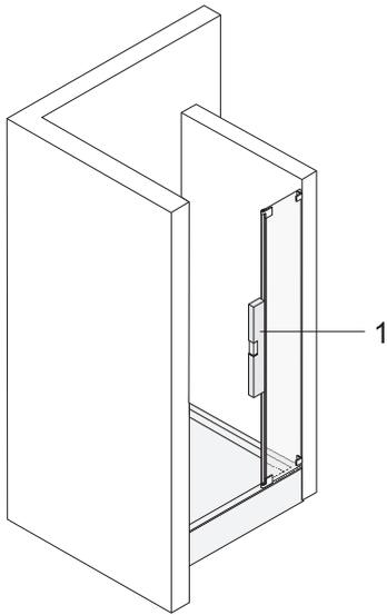
Festteile ausrichten und verschrauben
