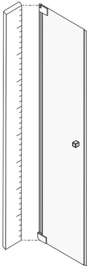
Scharniere an Wand montieren
