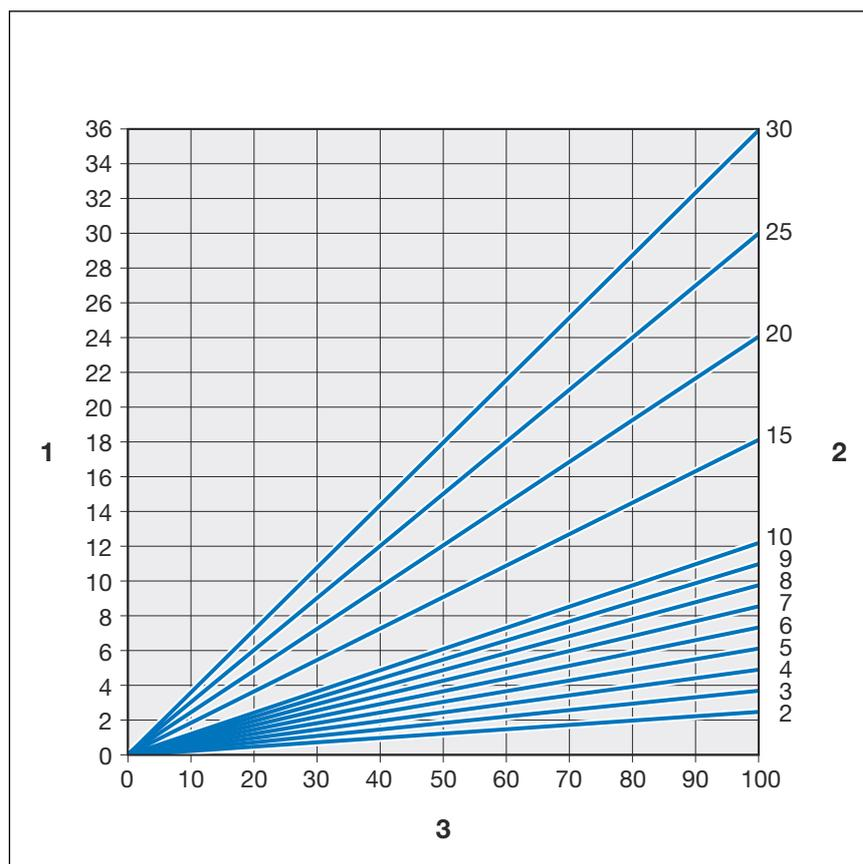
**Abb. 3: Längenausdehnung Stahlrohre**
