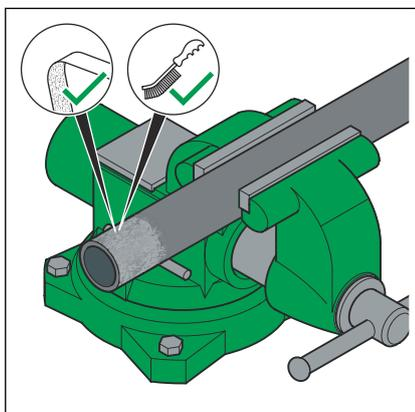
► Mit Drahtbürste, Reinigungsvlies oder Schleifpapier lose Schmutz- und Rostpartikel im Pressbereich entfernen.
