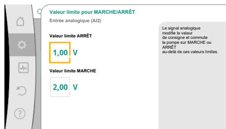
Fig. 80: Valeurs limites de la commande MARCHE/ARRÊT via signaux analogiques
