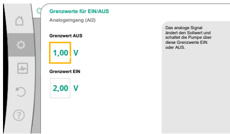
Fig. 80: Grenzwerte zur EIN/AUS-Steuerung über Analogsignale
