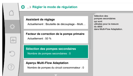
Fig. 57: Assistant de réglage – Sélection des pompes secondaires
