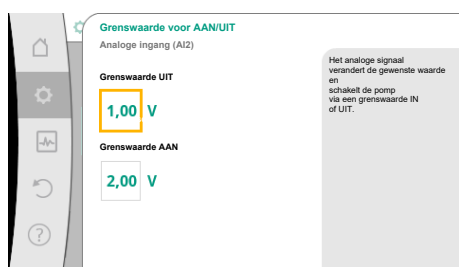
Fig. 80: Grenswaarden voor AAN/UIT-besturing via analoge signalen
