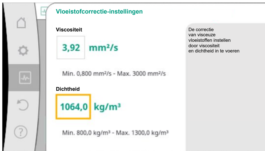
Fig. 97: Instelling van viscositeit en dichtheid
