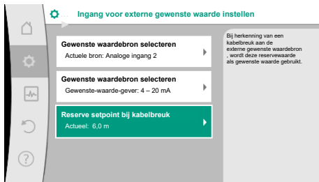
Fig. 83: Reserve setpoint bij kabelbreuk
