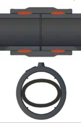
Unzulässige Spatbildung zwischen Rohr und Schweißfitting
