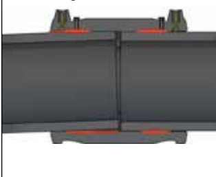
Verspannung während der Schweißung und Abkühlzeit
