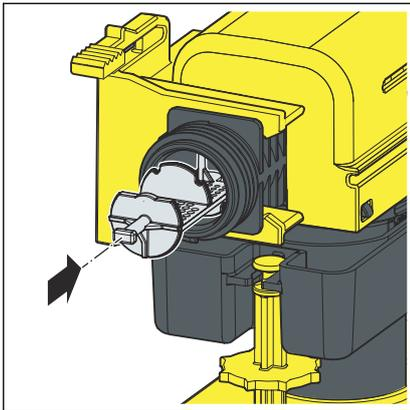
► Den Filter wieder in das Füllventilset einsetzen.
