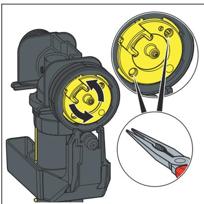
► Den Befestigungskranz durch eine 45°-Drehung mit einer Spitzzange gegen den Uhrzeigersinn lösen.
