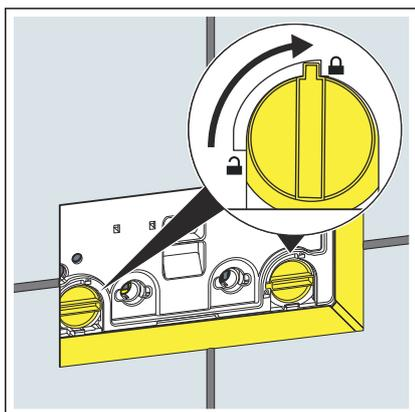
■ Die Verriegelung der Bauschutzplatte um 90° im Uhrzeigersinn drehen.
