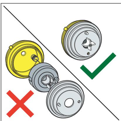
**HINWEIS!** Zerlegen Sie das Membranventil nicht in seine Bauteile, um Beschädigungen zu vermeiden.
