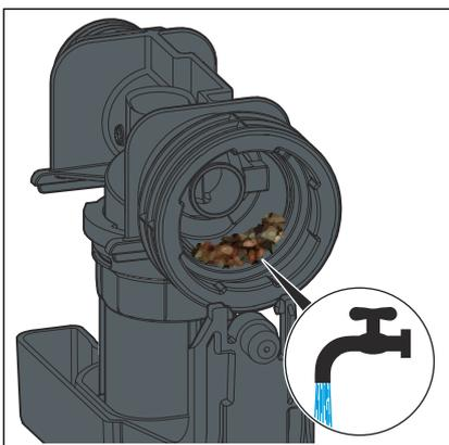
► Den Ventilsitz ebenfalls reinigen.
