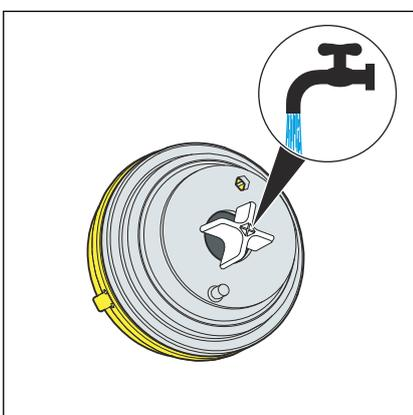
► Das Membranventil bei Bedarf unter fließendem Wasser reinigen.
