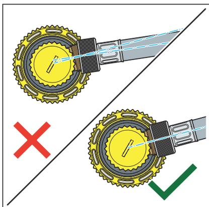
**HINWEIS!** Den Flexschlauch gerade auf das Eckventilgewinde aufsetzen .
