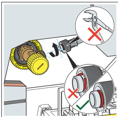
■ Den Flexschlauch und das Eckventil miteinander verschrauben.
