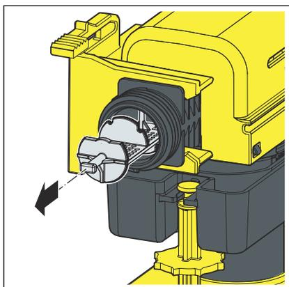
► Den Filter aus dem Füllventilset entfernen.
