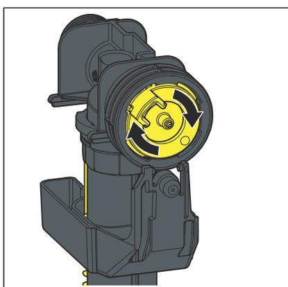
► Den Befestigungskranz durch eine 45°-Drehung im Uhrzeigersinn festziehen.
