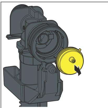
► Das Membranventil demontieren.
