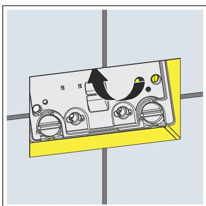
■ Die Bauschutzplatte in den Spülkasten einsetzen.
