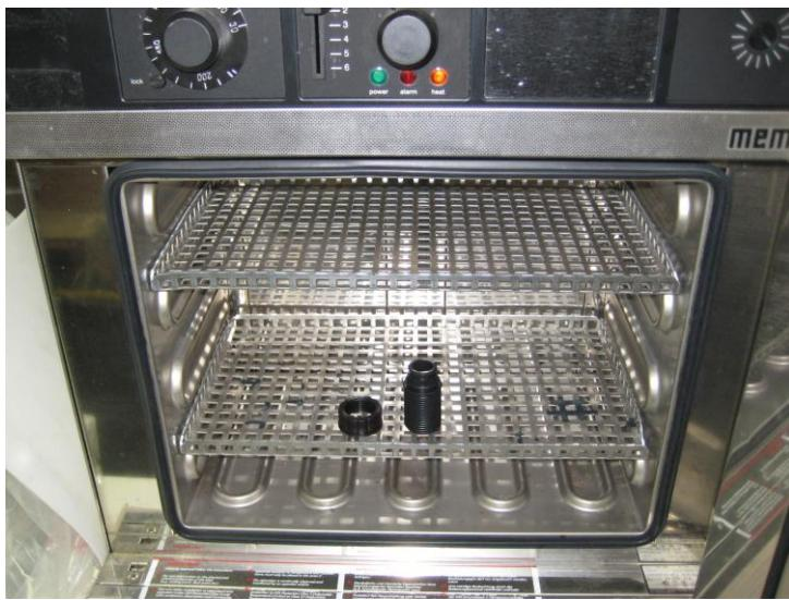
Einzelteile mittels Temperofen auf 70°C erwärmen
