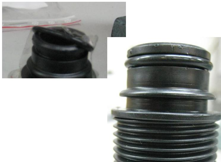
O-Ring in Nut der temperierten Gewindeverlängerung einsetzen
