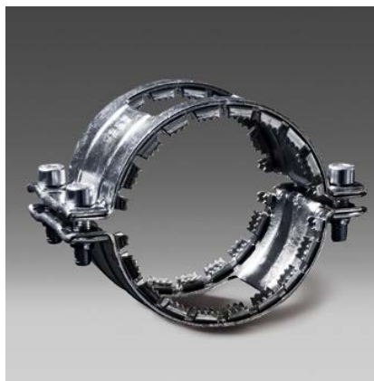
Kombi-Kralle Längskraftschlüssige Sicherungsschelle für alle Rapid-, CV- und CE-Verbinder über 0,5 bar Innendruck
