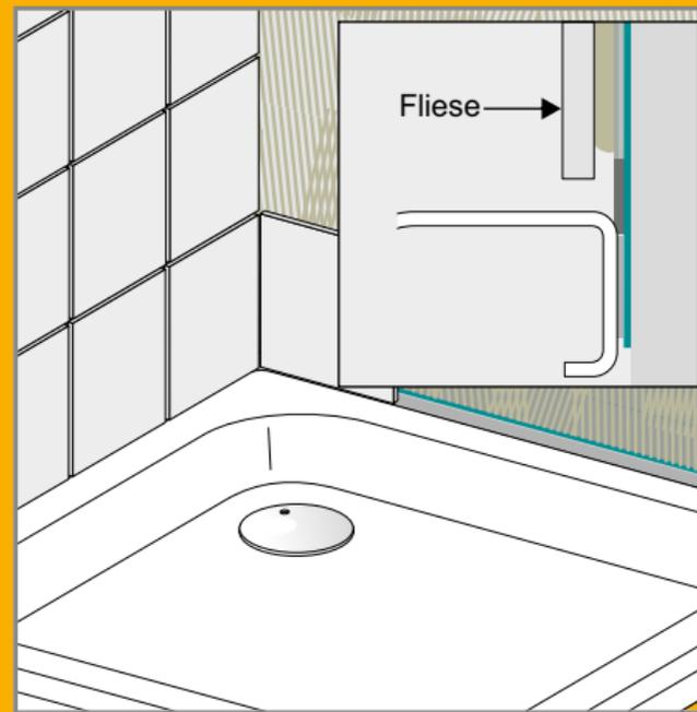
Beim Befliesen der Wand ist darauf zu achten, dass der Fliesenkleber ausschließlich oberhalb des Schutzprofils aufgetragen wird.
