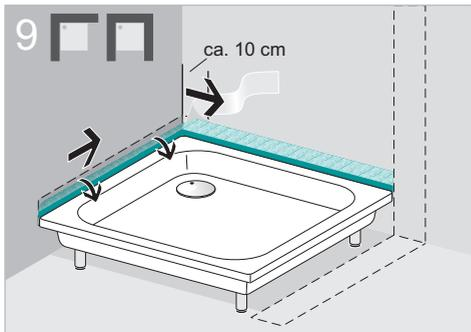
Wannendichtband **A** nach vorne umklappen und die breite Abdeckfolie bis ca. 10cm hinter der Wandecke entfernen.
