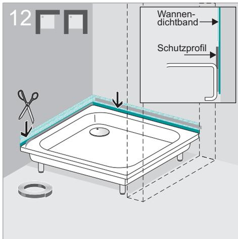
Schutzprofil **C** auf Länge der Wannenschenkel schneiden und auf das Wannendichtband **A** aufkleben.
