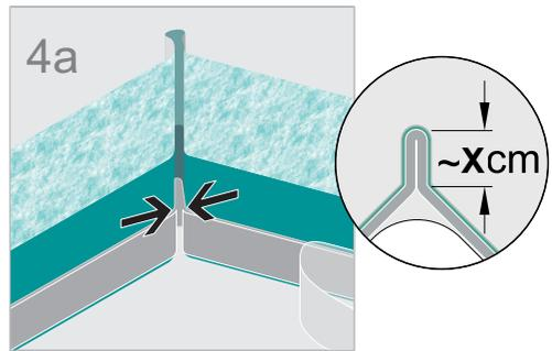
Das Wannendichtband **A** an einer Ecke der Bade- bzw. Duschwanne anlegen. Schutzstreifen stückweise vom Butyl abziehen und an den Wannenrand andrücken (1).
