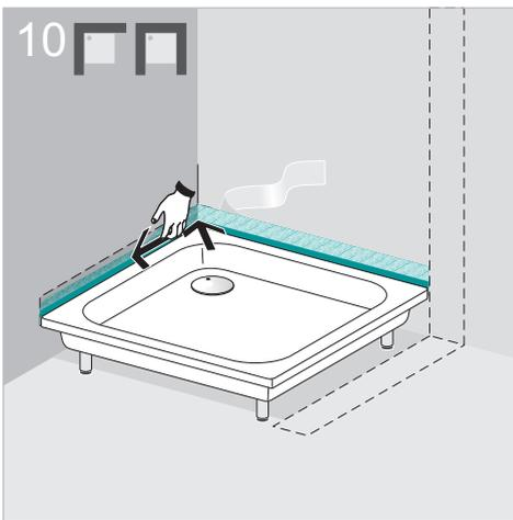
Anschließend das Wannendichtband **A** in die Ecke drücken und faltenfrei von der Ecke aus an die Wand streichen.
