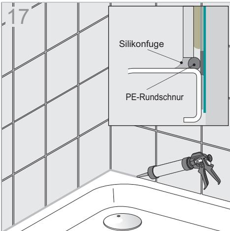
Die Fuge ist gemäß Abb. 5 mit einer Rundschnur zu füllen und anschließend mit Silikon zu versiegeln.
