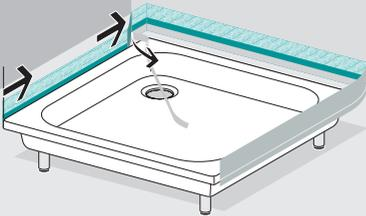
Bei der zweiten Ecke wird gemäß der ersten Ecke verfahren. Siehe Abb. 4 und 4a.
