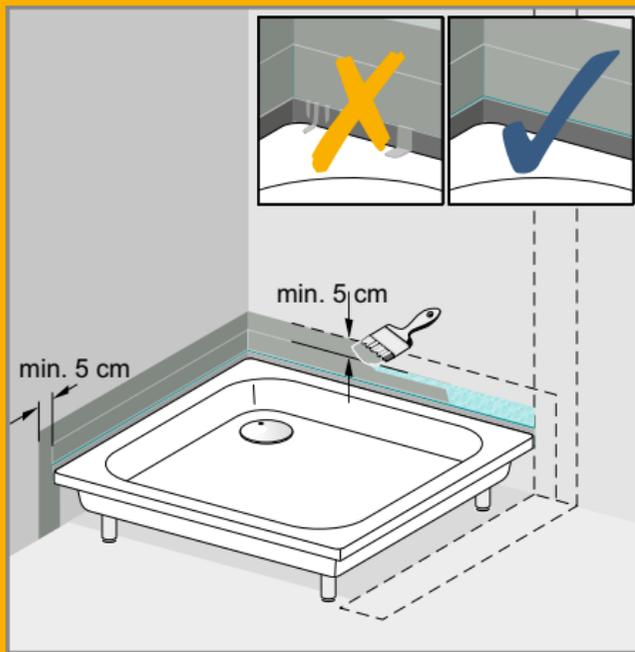
Das Wannendichtband muss mit der Verbundabdichtung min. 5 cm über den Kantenbereich des Wannendichtbandes hinweg deckend min. 2x überstrichen werden.
