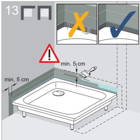
Das Wannendichtband **A** muss mit der Verbundabdichtung min. 5 cm über den Kantenbereich des Wannendichtbandes **A** hinweg deckend überstrichen werden.
