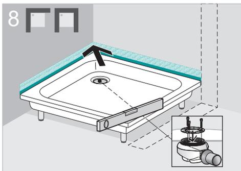
Den Ablauf gemäß Herstellerangaben montieren und auf Dichtigkeit prüfen.
