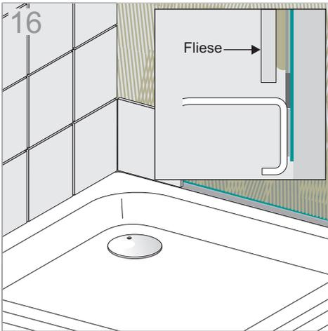
Beim Befliesen der Wand ist darauf zu achten, dass der Fliesenkleber ausschließlich oberhalb des Schutzprofils **C** aufgetragen wird. Beschädigungen der Wanne sind durch geeignete Maßnahmen zu vermeiden.
