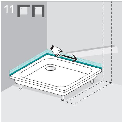
Nun den Klebeschutzstreifen weiter entfernen und das Wannendichtband **A** faltenfrei an die Wand kleben.
