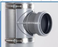
**Einfache Montage:** Loch bohren Ø 86 mm, entgraten, Dichtung aufkleben, Sattel-Abzweig aufsetzen, Schlauchschellen leicht andrehen. **FERTIG!**
