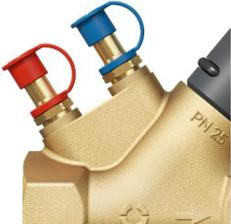
Jedes HydroControl V ist standardmäßig mit zwei HydroPort Hilfsventilen ausgestattet. Mit den HydroPort lässt sich Zubehör einfach und sicher per Schnappverschluss anschließen. HydroPort Ventile werden durch eine kurze Drehung mit einem Maulschlüssel SW13 geöffnet. Zur Druckmessung reicht eine Vierteldrehung, zum Entleeren und Füllen reicht eine dreiviertel Umdrehung.
