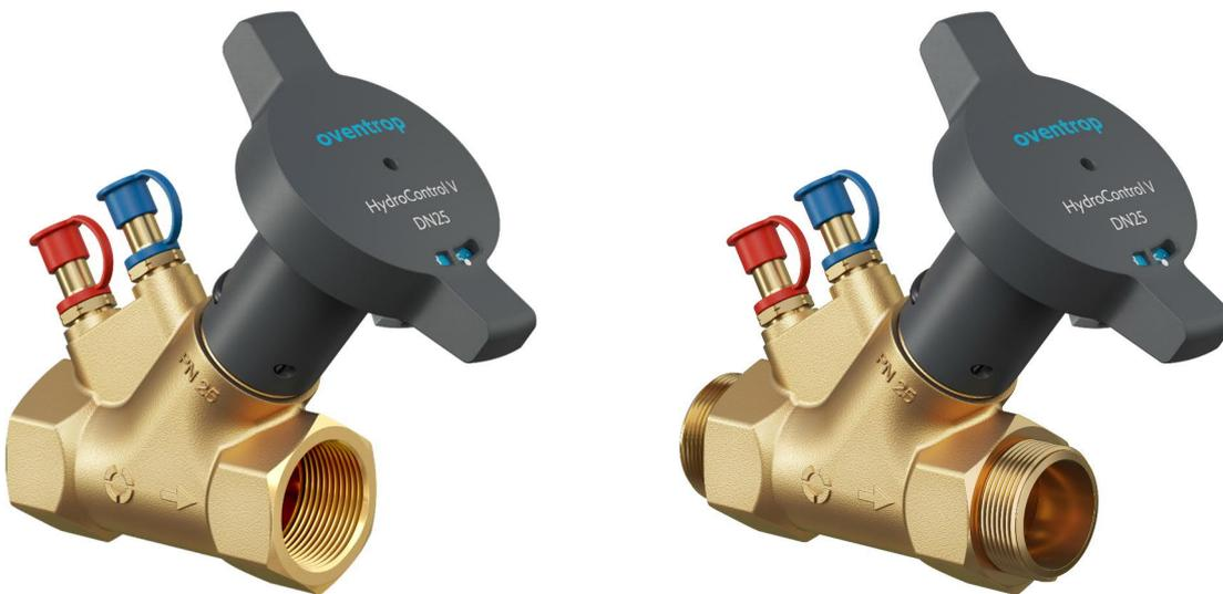
Strangregulierventil für den statischen hydraulischen Abgleich von Rohrnetzen in geschlossenen Heizungs- und Kühlwasseranlagen. Es bietet eine Messfunktion über den Ventilsitz.
