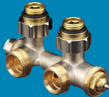
FORtech Anschlussarmatur Multiblock T für Heizkörper mit Rp 1/2" IG Eckform
