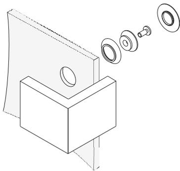
Glas/Glas-Winkel an kleines Festteil montieren
