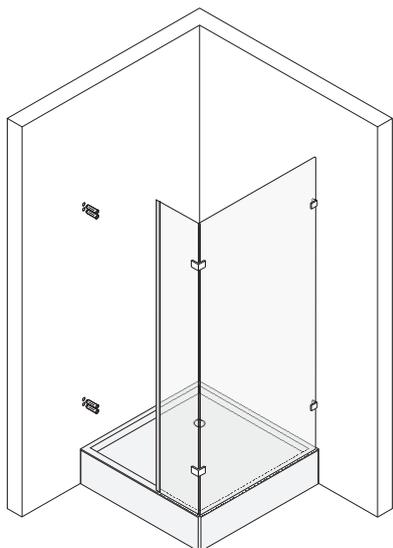
Türen montieren und ausrichten
