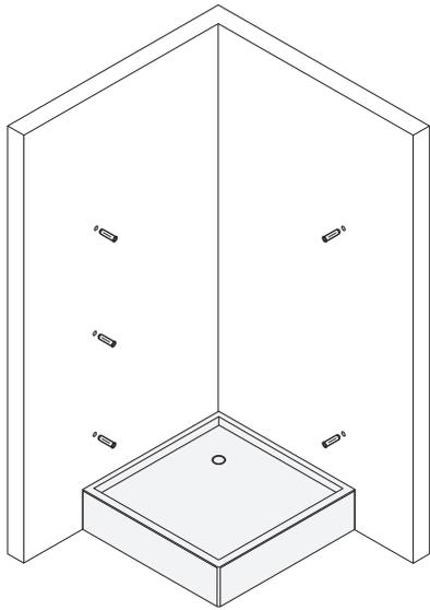
Befestigungslöcher Festteil und Alu flach 8x10 bohren und dübeln
