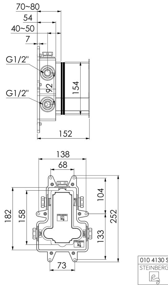
010 4130 S Unterputz Einbaukörper 1/2" Universell für alle Unterputzthermostate mit 3-Wege-Umsteller, Temperatur- und Mischfunktion
