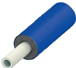
**TECElogo Mehrschichtverbundrohr vorgedämmt, 9 mm Dämmung, blau****Artikelnummer:** 8702420**Dimension:** 20 - RS 9 mm**Material:** PE-RT type II/Al/PE-RT type II**LE 1:** 75 m**LE 2:** 225 m**LE 3:** 450 m**Beschreibung:**
