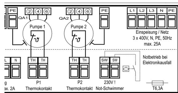
Anschlussschema des Motoranschlusses und der Zuleitung bei **230V Version:**
