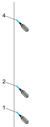
Abb. Zwei-Pumpensteuerung mit zwei Schwimmerschalter
