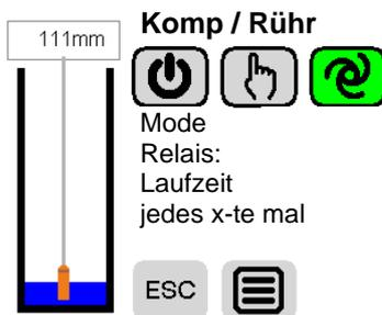
Nach Betätigen des Kompressor-Symbols gelangt man in das links gezeigte Menü, in dem die eingestellte Funktion und der Status angezeigt werden.
