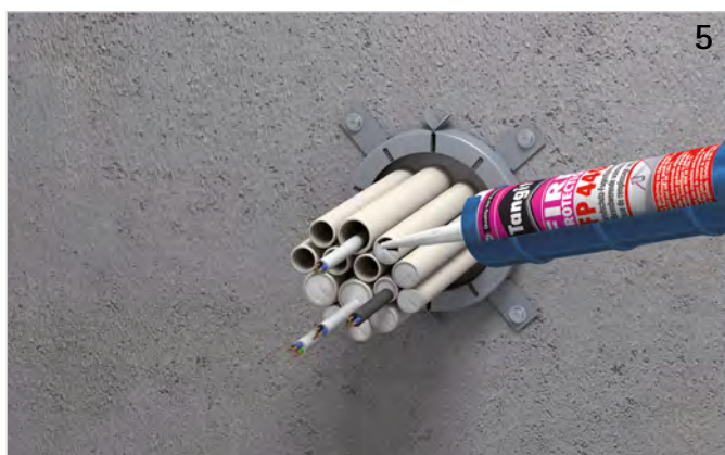
5 Die unbelegten Leerrohre und andere Restöffnungen rauchgasdicht mit z. B. Walraven Pacifyre® Sibralit DX Brandschutz-Fugenfüllmasse verschließen.
