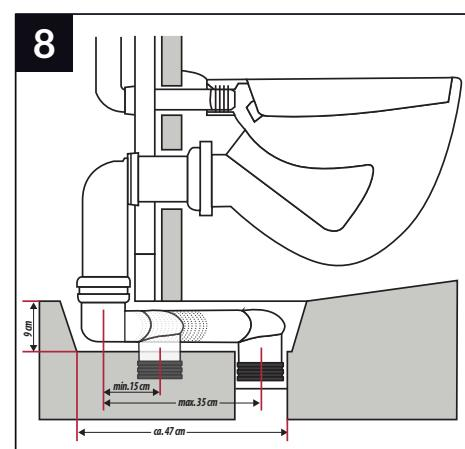
Abstand zwischen dem Ablaufrohr bodenseitig und dem Ablaufbogen am Vorwandelement heraus messen (jeweils Mittelpunkt). Maß am langen Teil des Versprungbogens (siehe Skala) in Verbindung eines Winkels anzeichnen und kürzen. Schnittstelle entgraten und den Bereich der Einschubtiefe mit dem mitgelieferten Schleifpapier aufrauen und anschließend säubern. **Schrumpfschlauch aufschieben. (Auf keinen Fall vergessen!!!)**
