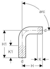
Werkstoff | Cu-DHP Kupfer CW024A (DIN EN 1412)
