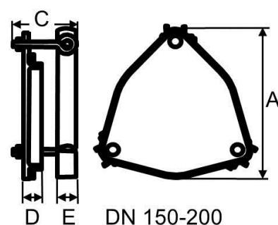
Gussformstück SML Enddeckel mit Klemmschelle inkl. Dichtung
