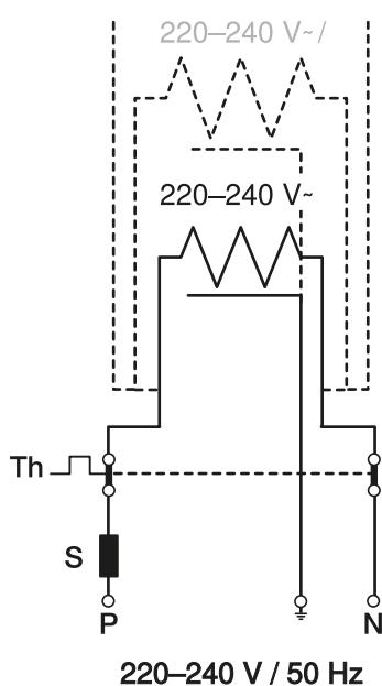
Aby móc wyłączyć podgrzewacz wpustu w ciepłych porach roku, należy zastosować termostat z czujnikiem temperatury zewnętrznej.
