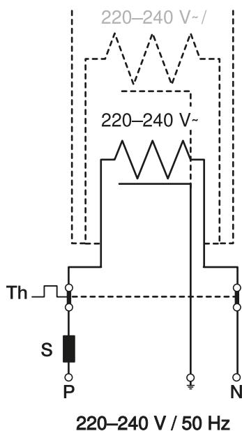
När värmeslingan ska stängas av under varma års-tider ska en termostat med utegivare användas.
