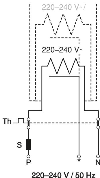
Brug termostaten med udendørstemperatursensor for at slukke for frostsikringen på de varme tids punkter af året.
