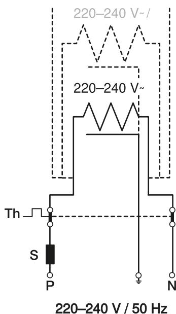
Para desligar a banda de aquecimento nas épocas mais quentes do ano, deve utilizar-se um termóstato com sensor externo.
