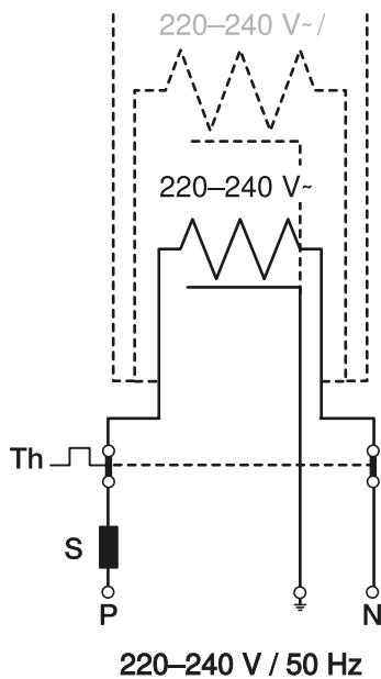
Para desconectar la banda calefactora en las estaciones cálidas se debe utilizar un termostato con sensor de temperatura exterior.
