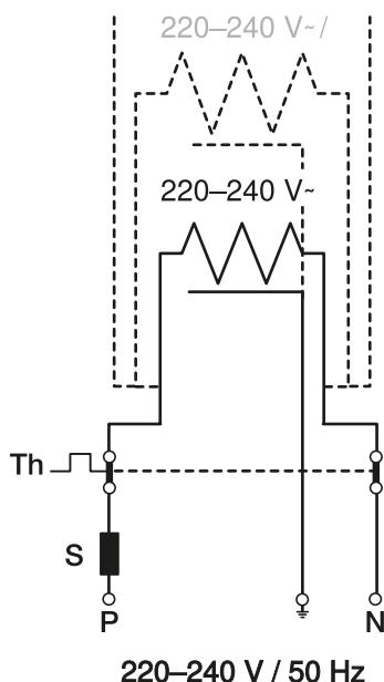
Pre vypnutie vyhrievacej pásy v teplom ročnom období použite termostat so snímačom vonkajšej teploty.
