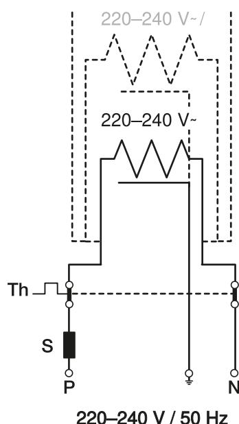
Lämpiminä vuodenaikoina lämmityselementin poistykentää varten on käytettävä ulkoanturilla varustettua termostaattia.
