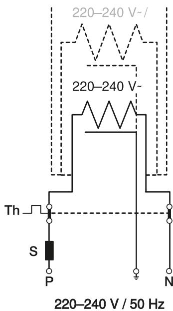
Для отключения греющего кабеля в теплое время года следует использовать термостат с датчиком наружной температуры.
