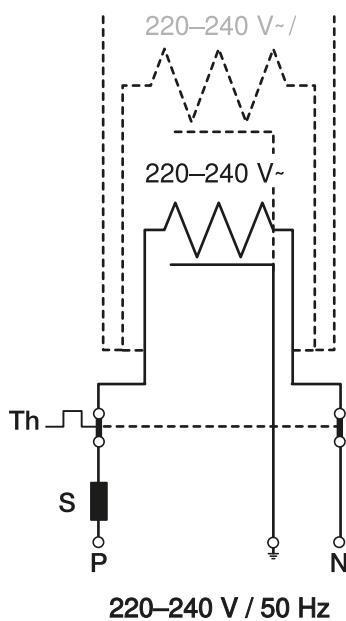
За изключването на нагревателната лента през топлите сезони трябва да се използва термостат със сензор за външна температура.
