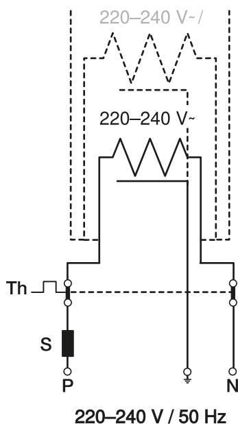
Per la disattivazione del nastro riscaldante nelle stagioni calde, utilizzare un termostato con sensore di temperatura esterna.
