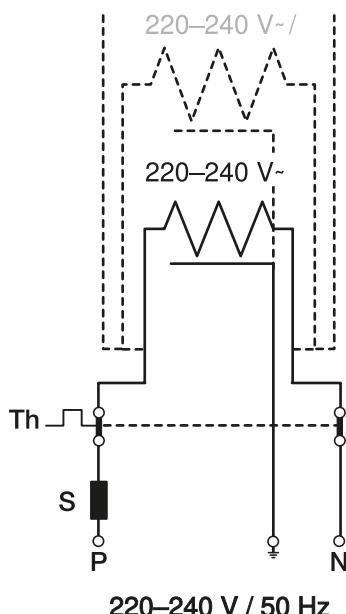
Isıtıcı bandı yılın sıcak dönemlerinde kapatmak için dış sensörlü termostat kullanılmalıdır.
