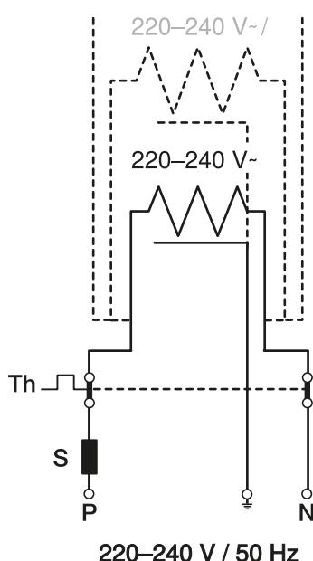
Lai siltajā gadalaikā izslēgtu apsildāmo lenti, izmantojiet termostatu ar ārējo devēju.
