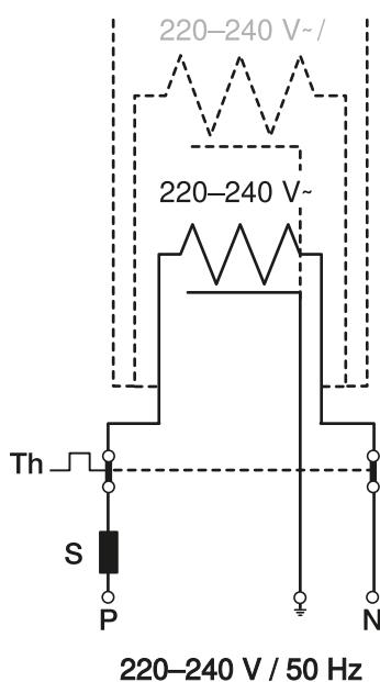
Pentru oprirea benzii de încălzire pe perioada anotimpurilor calde, trebuie să se utilizeze un termostat cu senzor de temperatură exterioară.
