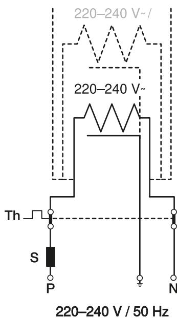
Για την απενεργοποίηση της θερμαντικής ταινίας κατά τις θερμές περιόδους του έτους, πρέπει να χρησιμοποιείται ένας θερμοστάτης με εξωτερικό αισθητήρα.
